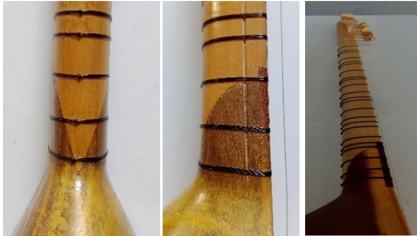
Resim 9. Bağlama sapı birleştirme Kurt Ağzı örnekleri (Cevahir Karaca çalgı koleksiyonundan)
